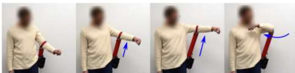
Рисунок 7. Пневматический привод шкива, используемый для поднятия локтя за счет приложения силы со стороны бедра. Адаптировано из [5].
